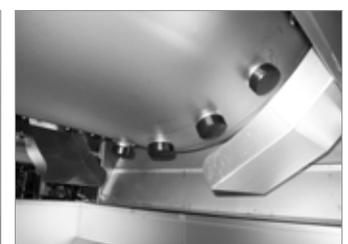
Die pneumatische Pressen der Serie X sind für größere Weinbaubetriebe bestimmt. Die Pressen ermöglichen das Traubenpressen bei verschiedenen Zeitintervallen, bei Überdrücken, bei Anwesenheit oder Abwesenheit des Sauerstoffs, als auch Mazeration der Traubenmasse.
