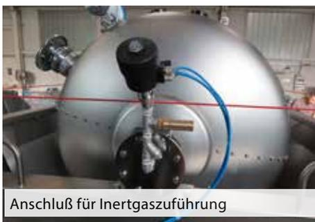
Anschluß für Inertgaszuführung
