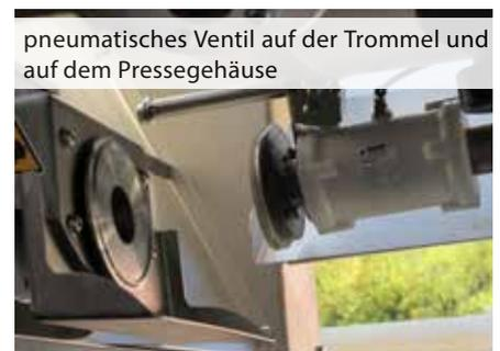
pneumatisches Ventil auf der Trommel und auf dem Pressegehäuse
